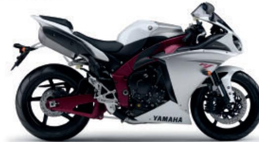
• Völlig neue R1-Generation mit Moto-GP DNA • Flüssigkeitsgekühlter 4-Zylinder-4-Takt-DOHC-Motor mit 16 Ventilen und 998 ccm Hubraum • Kurbelwelle mit jeweils um 90° versetzten Hubzapfen und Zündversatz: 270° - 180° - 90° - 180° • 133,9 kW (182 PS) und 115,5 Nm (Leistungsmessung ohne Staudruck)
